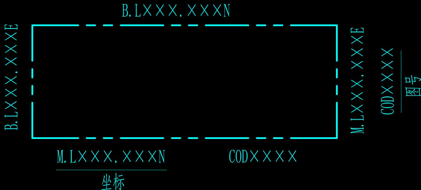
B. L——表示装置边界； M. L——表示接续线； COD——表示接续图
