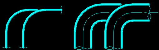
管道转折后投影重叠，将下面的管
