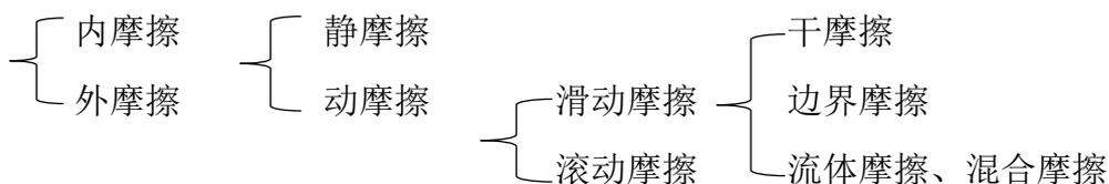
3. 按摩擦状态不同，摩擦可分为干摩擦、边界摩擦、流体摩擦和混合摩擦。
